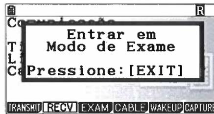
5- A calculadora desliga-se e ao voltar a ligar surge uma moldura verde à volta do menu e um "R" (de modo restrito) a piscar no canto superior esquerdo. Este "R" pisca relativamente rápido. Passados 15 minutos, a velocidade de apresentação do modo de exame diminui, ficando mais lento a apresentação do "R" no visor da calculadora.
